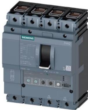
interruttore 3VA2 IEC frame 160 classe del potere di interruzione E Icu=200 kA @ 415 V a 4 poli, protezione impianto ETU350, LSI, In=25A protezione da sovraccarico Ir=10A ... 25A protezione da cortocircuito I<sub>sd</sub>=1,5 ... 10xI<sub>r</sub>, I<sub>i</sub>=12xI<sub>n</sub> protezione del conduttore di neutro impostabile (OFF, 100 %) connessione a morsetto
