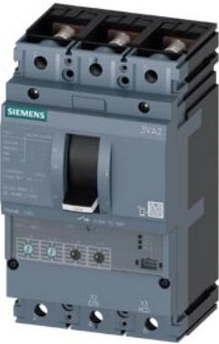
interruttore 3VA2 IEC frame 160 classe del potere di interruzione E Icu=200 kA @ 415 V a 3 poli, protezione impianto ETU330, LIG, In=25A protezione da sovraccarico Ir=10A ... 25A protezione da cortocircuito Ii=1,5 ... 12 x In protezione da guasto verso terra Ig=0,6 ... 1 x In, tg=0,1/0,3s attacco piatto a vite
