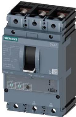
interruttore 3VA2 IEC frame 160 classe del potere di interruzione E Icu=200 kA @ 415 V a 3 poli, protezione impianto ETU320, LI, In=25A protezione da sovraccarico Ir=10A ... 25A protezione da cortocircuito Ii=1,5 ... 12 x In attacco piatto a vite
