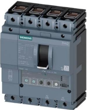
Interruttore automatico 3VA2 IEC Frame 160 Classe del potere di interruzione L Icu=150kA @ 415V a 4 poli, protezione impianto ETU330, LIG, In=160A protezione da sovraccarico Ir=63A...160A protezione da cortocircuito Ii=1,5...10 x In protezione del conduttore di neutro impostabile (OFF, 50%, 100%) protezione da guasto verso terra Ig=0,2...1 x In= tg=0,1/0,3s connessione a morsetto
