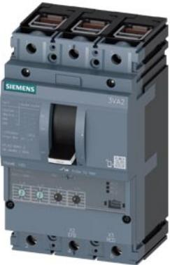
Interruttore automatico 3VA2 IEC Frame 160 Classe del potere di interruzione L Icu=150kA @ 415V a 3 poli, protezione impianto ETU330, LIG, In=160A protezione da sovraccarico Ir=63A...160A protezione da cortocircuito Ii=1,5...10 x In protezione da guasto verso terra Ig=0,2...1 x In, tg=0,1/0,3s connessione a morsetto
