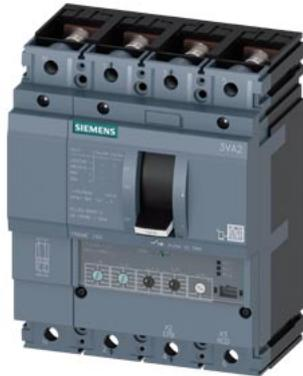
Interruttore automatico 3VA2 IEC Frame 160 Classe del potere di interruzione C Icu=110kA @ 415V a 4 poli, protezione impianto ETU350, LSI, In=160A protezione da sovraccarico Ir=63A...160A protezione da cortocircuito I<sub>sd</sub>=1,5...10 x I<sub>r</sub>, I<sub>i</sub>=10 x I<sub>n</sub> protezione del conduttore di neutro impostabile (OFF, 50%, 100%) attacco piatto a vite
