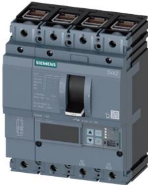
interruttore 3VA2 IEC frame 160 classe del potere di interruzione E Icu=200 kA @ 415 V a 4 poli, protezione impianto ETU860, LSIG, In=160A protezione da sovraccarico Ir=63A ... 160A protezione da cortocircuito I<sub>sd</sub>=0,6 ... 10 x I<sub>n</sub>, I<sub>i</sub>=1,5 ... 12xI<sub>n</sub> protezione del conduttore di neutro impostabile (OFF, fino a 100 %) connessione a morsetto
