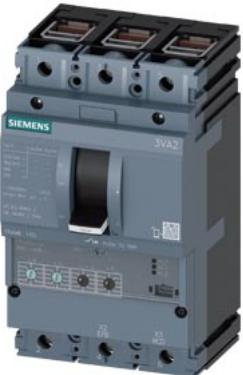
interruttore 3VA2 IEC frame 160 classe del potere di interruzione E Icu=200 kA @ 415 V a 3 poli, protezione impianto ETU350, LSI, In=160A protezione da sovraccarico Ir=63A ... 160A protezione da cortocircuito Isd=1,5 ... 10xIr, Ii=12xIn connessione a morsetto
