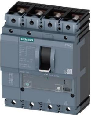
Interruttore automatico 3VA2 IEC Frame 160 Classe del potere di interruzione L Icu=150kA @ 415V a 4 poli, protezione impianto ETU340, ELISA LI, In=100A protezione da sovraccarico Ir=40A...100A protezione da cortocircuito Ii=15 x In protezione del conduttore di neutro impostabile (OFF, 50%, 100%) attacco piatto a vite
