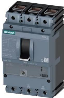
Interruttore automatico 3VA2 IEC Frame 160 Classe del potere di interruzione C Icu=110kA @ 415V a 3 poli, protezione avviatore ETU310M, I, In=100A senza protezione da sovraccarico protezione da cortocircuito Ii=3...15 x In connessione a morsetto
