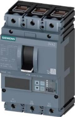
interruttore automatico 3VA2 IEC Frame 160 classe del potere di interruzione C Icu=110 kA con 415 V a 3 poli, protezione motore ETU550M, LSI, In=100 A protezione da sovraccarico Ir=40 A ... 100 A protezione da cortocircuito Isd=1,2... 15x In,li=3...15x In in connessione a morsetto
