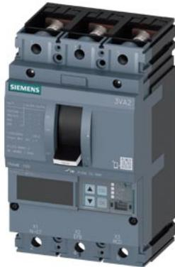
interruttore automatico 3VA2 IEC Frame 160 classe del potere di interruzione C Icu=110 kA con 415 V a 3 poli, protezione motore ETU550M, LSI, In=100 A protezione da sovraccarico Ir=40 A ... 100 A protezione da cortocircuito I<sub>sd</sub>=1,2... 15x I<sub>n</sub>, I<sub>li</sub>=3...15x I<sub>n</sub> attacchi piatti a vite
