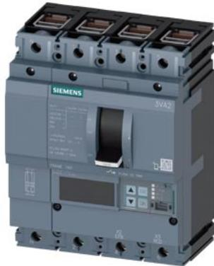
Interruttore automatico 3VA2 IEC Frame 160 Classe del potere di interruzione C Icu=110kA @ 415V a 4 poli, protezione impianto ETU550, LSI, In=100A protezione da sovraccarico Ir=40A...100A protezione da cortocircuito I<sub>sd</sub>=0,6..10x I<sub>n</sub>, I<sub>i</sub>=1,5..12x I<sub>n</sub> protezione del conduttore di neutro impostabile (OFF, fino al 160%) connessione a morsetto
