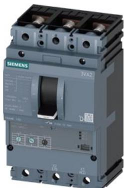
interruttore 3VA2 IEC frame 160 classe del potere di interruzione E Icu=200 kA @ 415 V a 3 poli, protezione motore ETU350M, LSI, In=100A protezione da sovraccarico Ir=40 A ... 100A protezione da cortocircuito Isd=3 ... 15xIr, li=15xIn attacco piatto a vite
