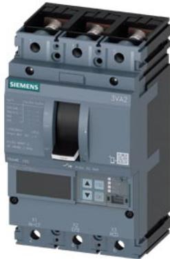
interruttore 3VA2 IEC frame 160 classe del potere di interruzione E Icu=200 kA @ 415 V a 3 poli, protezione impianto ETU850, LSI, In=100A protezione da sovraccarico Ir=40 A ... 100A protezione da cortocircuito Isd=0,6 ... 10 x In, li=1,5 ... 12xIn attacco piatto a vite
