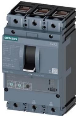
interruttore 3VA2 IEC frame 160 classe del potere di interruzione E Icu=200 kA @ 415 V a 3 poli, protezione impianto ETU320, LI, In=100A protezione da sovraccarico Ir=40 A ... 100A protezione da cortocircuito li=1,5 ... 12 x In connessione a morsetto
