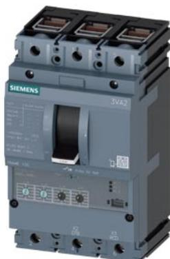
Interruttore automatico 3VA2 IEC Frame 100 Classe del potere di interruzione L Icu=150kA @ 415V a 3 poli, protezione impianto ETU330, LIG, In=63A protezione da sovraccarico Ir=25A...63A protezione da cortocircuito Ii=1,5...12 x In protezione da guasto verso terra Ig=0,25... 1 x In, tg=0,1/0,3s connessione a morsetto
