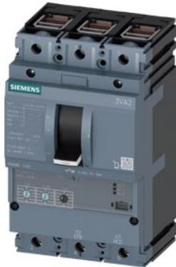
Interruttore automatico 3VA2 IEC Frame 100 Classe del potere di interruzione L Icu=150kA @ 415V a 3 poli, protezione impianto ETU320, LI, In=63A protezione da sovraccarico Ir=25A...63A protezione da cortocircuito Ii=1,5...12 x In connessione a morsetto
