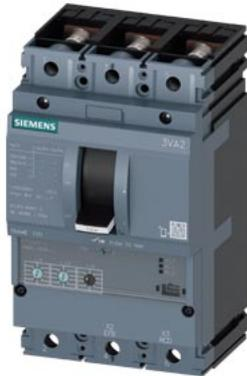
Interruttore automatico 3VA2 IEC Frame 100 Classe del potere di interruzione L Icu=150kA @ 415V a 3 poli, protezione impianto ETU320, LI, In=63A protezione da sovraccarico Ir=25A...63A protezione da cortocircuito Ii=1,5...12 x In attacco piatto a vite
