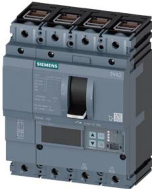
Interruttore automatico 3VA2 IEC Frame 100 Classe del potere di interruzione C Icu=110kA @ 415V a 4 poli, protezione impianto ETU550, LSI, In=63A protezione da sovraccarico Ir=25A...63A protezione da cortocircuito I<sub>sd</sub>=0,6..10x I<sub>n</sub>, I<sub>i</sub>=1,5..12x I<sub>n</sub> protezione del conduttore di neutro impostabile (OFF, fino al 160%) connessione a morsetto
