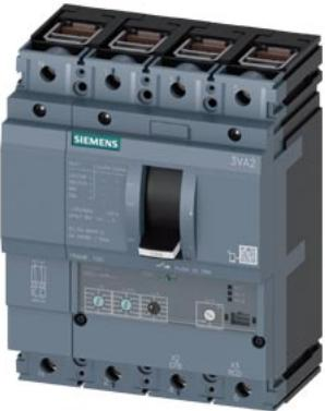
Interruttore automatico 3VA2 IEC Frame 100 Classe del potere di interruzione C Icu=110kA @ 415V a 4 poli, protezione impianto ETU320, LI, In=63A protezione da sovraccarico Ir=25A...63A protezione da cortocircuito Ii=1,5...12 x In protezione del conduttore di neutro impostabile (OFF, 100%) connessione a morsetto
