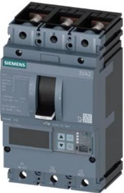
Interruttore automatico 3VA2 IEC Frame 100 Classe del potere di interruzione L Icu=150kA @ 415V a 3 poli, protezione impianto ETU560, LSIG, In=40A protezione da sovraccarico Ir=16A...40A protezione da cortocircuito Isd=0,6..10x In, li=1,5..12x In protezione del conduttore di neutro opzionale con trasformatore di corrente, fino a 160% protezione da guasto verso terra, disinseribile Ig=0,4... 1 x In, tg=0,05-0,8s attacco piatto a vite
