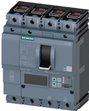
Interruttore automatico 3VA2 IEC Frame 100 Classe del potere di interruzione C Icu=110kA @ 415V a 4 poli, protezione impianto ETU860, LSIG, In=40A protezione da sovraccarico Ir=16A...40A protezione da cortocircuito I<sub>sd</sub>=0,6..10x I<sub>n</sub>, I<sub>i</sub>=1,5..12x I<sub>n</sub> protezione del conduttore di neutro impostabile (OFF, fino al 160%) protezione da guasto verso terra, disinseribile I<sub>g</sub>=0,4...1 x I<sub>n</sub>= tg=0,05-0,8s connessione a morsetto
