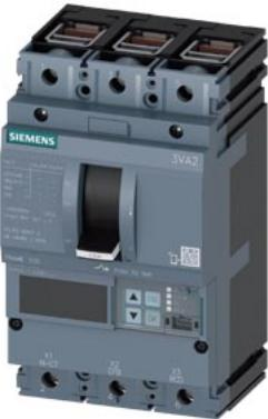
Interruttore automatico 3VA2 IEC Frame 100 Classe del potere di interruzione C Icu=110kA @ 415V a 3 poli, protezione impianto ETU560, LSIG, In=40A protezione da sovraccarico Ir=16A...40A protezione da cortocircuito lsd=0,6..10x In, li=1,5..12x In protezione del conduttore di neutro opzionale con trasformatore di corrente, fino a 160% protezione da guasto verso terra, disinseribile Ig=0,4... 1 x In, tg=0,05-0,8s connessione a morsetto
