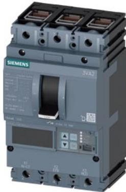
Interruttore automatico 3VA2 IEC Frame 100 Classe del potere di interruzione H Icu=85kA @ 415V a 3 poli, protezione impianto ETU850, LSI, In=40A protezione da sovraccarico Ir=16A...40A protezione da cortocircuito Isd=0,6..10x In, li=1,5..12x In protezione del conduttore di neutro opzionale con trasformatore di corrente, fino a 160% connessione a morsetto
