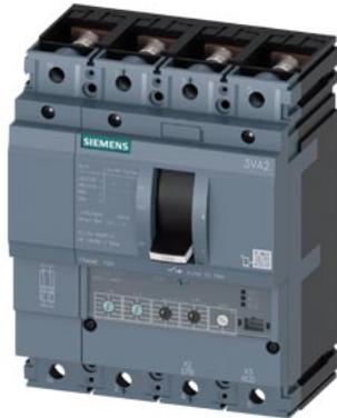
Interruttore automatico 3VA2 IEC Frame 100 Classe del potere di interruzione H Icu=85kA @ 415V a 4 poli, protezione impianto ETU350, LSI, In=40A protezione da sovraccarico Ir=16A...40A protezione da cortocircuito I<sub>sd</sub>=1,5...10 x I<sub>r</sub>, I<sub>i</sub>=12 x I<sub>n</sub> protezione del conduttore di neutro impostabile (OFF, 100%) attacco piatto a vite
