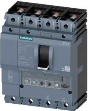
Interruttore automatico 3VA2 IEC Frame 100 Classe del potere di interruzione M Icu=55kA @ 415V a 4 poli, protezione impianto ETU350, LSI, In=40A protezione da sovraccarico Ir=16A...40A protezione da cortocircuito Isd=1,5...10 x Ir, li=12 x In protezione del conduttore di neutro impostabile (OFF, 100%) attacco piatto a vite
