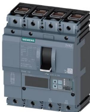
Interruttore automatico 3VA2 IEC Frame 100 Classe del potere di interruzione C Icu=110kA @ 415V a 4 poli, protezione impianto ETU860, LSIG, In=25A protezione da sovraccarico Ir=10A...25A protezione da cortocircuito I<sub>sd</sub>=0,6..10x I<sub>n</sub>, I<sub>i</sub>=1,5..12x I<sub>n</sub> protezione del conduttore di neutro impostabile (OFF, fino al 160%) protezione da guasto verso terra, disinseribile I<sub>g</sub>=0,2...1 x I<sub>n</sub>= tg=0,05-0,8s connessione a morsetto
