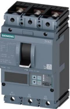
Interruttore automatico 3VA2 IEC Frame 100 Classe del potere di interruzione C Icu=110kA @ 415V a 3 poli, protezione impianto ETU850, LSI, In=25A protezione da sovraccarico Ir=10A...25A protezione da cortocircuito Isd=0,6..10x In, Ii=1,5..12x In protezione del conduttore di neutro opzionale con trasformatore di corrente, fino a 160% attacco piatto a vite
