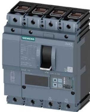
Interruttore automatico 3VA2 IEC Frame 100 Classe del potere di interruzione H Icu=85kA @ 415V a 4 poli, protezione impianto ETU860, LSIG, In=25A protezione da sovraccarico Ir=10A...25A protezione da cortocircuito Isd=0,6..10x In, li=1,5..12x In protezione del conduttore di neutro impostabile (OFF, fino al 160%) protezione da guasto verso terra, disinseribile Ig=0,2...1 x In= tg=0,05-0,8s connessione a morsetto
