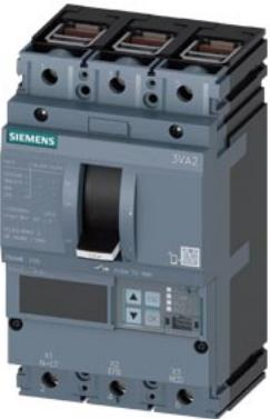
Interruttore automatico 3VA2 IEC Frame 100 Classe del potere di interruzione H Icu=85kA @ 415V a 3 poli, protezione impianto ETU550, LSI, In=25A protezione da sovraccarico Ir=10A...25A protezione da cortocircuito Isd=0,6..10x In, Ii=1,5..12x In protezione del conduttore di neutro opzionale con trasformatore di corrente, fino a 160% connessione a morsetto
