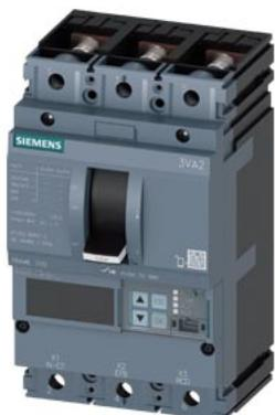
Interruttore automatico 3VA2 IEC Frame 100 Classe del potere di interruzione H Icu=85kA @ 415V a 3 poli, protezione impianto ETU550, LSI, In=25A protezione da sovraccarico Ir=10A...25A protezione da cortocircuito Isd=0,6..10x In, li=1,5..12x In protezione del conduttore di neutro opzionale con trasformatore di corrente, fino a 160% attacco piatto a vite
