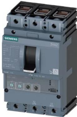
Interruttore automatico 3VA2 IEC Frame 100 Classe del potere di interruzione M Icu=55kA @ 415V a 3 poli, protezione impianto ETU330, LIG, In=25A protezione da sovraccarico Ir=10A...25A protezione da cortocircuito Ii=1,5...12 x In protezione da guasto verso terra Ig=0,6... 1 x In, tg=0,1/0,3s connessione a morsetto
