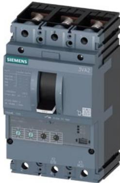
Interruttore automatico 3VA2 IEC Frame 100 Classe del potere di interruzione M Icu=55kA @ 415V a 3 poli, protezione impianto ETU330, LIG, In=25A protezione da sovraccarico Ir=10A...25A protezione da cortocircuito Ii=1,5...12 x In protezione da guasto verso terra Ig=0,6... 1 x In, tg=0,1/0,3s attacco piatto a vite
