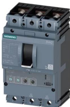
Interruttore automatico 3VA2 IEC Frame 100 Classe del potere di interruzione L Icu=150kA @ 415V a 3 poli, protezione impianto ETU330, LIG, In=100A protezione da sovraccarico Ir=40A...100A protezione da cortocircuito li=1,5...12 x In protezione da guasto verso terra Ig=0,2...1 x In, tg=0,1/0,3s attacco piatto a vite
