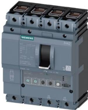
Interruttore automatico 3VA2 IEC Frame 100 Classe del potere di interruzione C Icu=110kA @ 415V a 4 poli, protezione impianto ETU330, LIG, In=100A protezione da sovraccarico Ir=40A...100A protezione da cortocircuito li=1,5...12 x In protezione del conduttore di neutro impostabile (OFF, 50%, 100%) protezione da guasto verso terra Ig=0,2...1 x In= tg=0,1/0,3s connessione a morsetto
