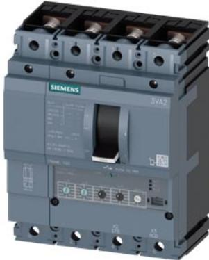
Interruttore automatico 3VA2 IEC Frame 100 Classe del potere di interruzione H Icu=85kA @ 415V a 4 poli, protezione impianto ETU350, LSI, In=100A protezione da sovraccarico Ir=40A...100A protezione da cortocircuito I<sub>sd</sub>=1,5...10 x I<sub>r</sub>, I<sub>i</sub>=12 x I<sub>n</sub> protezione del conduttore di neutro impostabile (OFF, 50%, 100%) attacco piatto a vite
