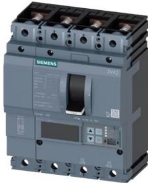
Interruttore automatico 3VA2 IEC Frame 100 Classe del potere di interruzione M Icu=55kA @ 415V a 4 poli, protezione impianto ETU560, LSIg, In=100A protezione da sovraccarico Ir=40A...100A protezione da cortocircuito I<sub>sd</sub>=0,6..10x I<sub>n</sub>, I<sub>i</sub>=1,5..12x I<sub>n</sub> protezione del conduttore di neutro impostabile (OFF, fino a 100%) protezione da guasto verso terra, disinseribile I<sub>g</sub>=0,2...1 x I<sub>n</sub>= tg=0,05-0,8s attacco piatto a vite
