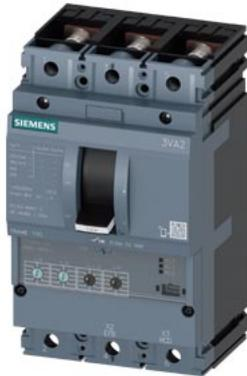
Interruttore automatico 3VA2 IEC Frame 100 Classe del potere di interruzione M Icu=55kA @ 415V a 3 poli, protezione impianto ETU350, LSI, In=100A protezione da sovraccarico Ir=40A...100A protezione da cortocircuito I<sub>sd</sub>=1,5...10 x I<sub>r</sub>, I<sub>i</sub>=12 x I<sub>n</sub> attacco piatto a vite
