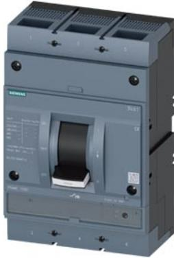
interruttore automatico 3VA1 IEC Frame 1000 classe del potere di interruzione M Icu=55 kA con 415 V a 3 poli, protezione avviatore TM120M, AM, In=800 A senza protezione da sovraccarico protezione da cortocircuito li=6 ... 12 x In attacchi piatti a vite
