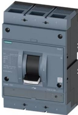
interruttore automatico 3VA1 IEC Frame 1000 classe del potere di interruzione C Icu=110 kA con 415 V a 3 poli, protezione avviatore TM120M, AM, In=630 A senza protezione da sovraccarico protezione da cortocircuito li=8 ... 15 x In attacchi piatti a vite
