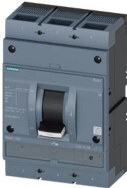
interruttore automatico 3VA1 IEC Frame 1000 classe del potere di interruzione M Icu=55 kA con 415 V a 3 poli, protezione avviatore TM120M, AM, In=630 A senza protezione da sovraccarico protezione da cortocircuito Ii=8 ... 15 x In attacchi piatti a vite
