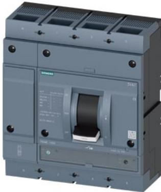
interruttore automatico 3VA1 IEC Frame 1000 classe del potere di interruzione M Icu=55 kA con 415 V a 4 poli, protezione impianto TM240, ATAM, In=630 A protezione da sovraccarico Ir=440 A ... 630 A protezione da cortocircuito Ii=5 ... 10 x In protezione del conduttore di neutro 100 % attacchi piatti a vite
