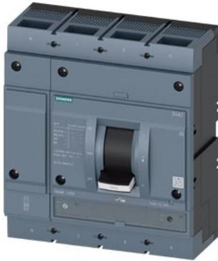
interruttore automatico 3VA1 IEC Frame 1000 classe del potere di interruzione M Icu=55 kA con 415 V a 4 poli, protezione impianto TM240, ATAM, In=1000 A protezione da sovraccarico Ir=700 A ... 1000 A protezione da cortocircuito li=5 ... 10 x In protezione del conduttore di neutro 100 % attacchi piatti a vite
