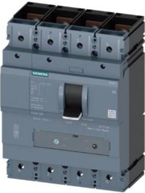
interruttore automatico 3VA1 IEC Frame 630 classe del potere di interruzione M Icu=55 kA con 415V a 4 poli, protezione impianto TM240, ATAM, In=630 A protezione da sovraccarico Ir=440 A ... 630 A protezione da cortocircuito Ii=4 ... 8 x In conduttore di neutro non protetto attacchi piatti a vite
