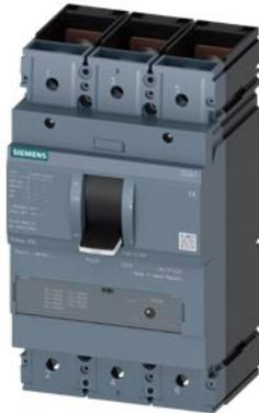
interruttore automatico 3VA1 IEC Frame 630 classe del potere di interruzione M Icu=55 kA con 415 V a 3 poli, protezione avviatore TM120M, AM, In=500 A senza protezione da sovraccarico protezione da cortocircuito li=5 ... 10 x In attacchi piatti a vite
