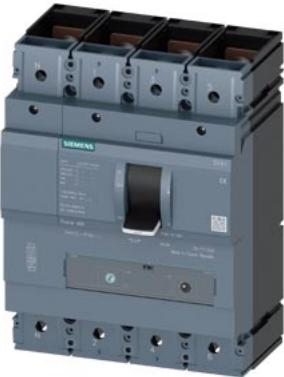
interruttore automatico 3VA1 IEC Frame 400 classe del potere di interruzione N Icu=36 kA con 415 V a 4 poli, protezione impianto TM240, ATAM, In=320 A protezione da sovraccarico Ir=224 A ... 320 A protezione da cortocircuito Ii=5 ... 10 x In protezione del conduttore di neutro 50 % attacchi piatti a vite
