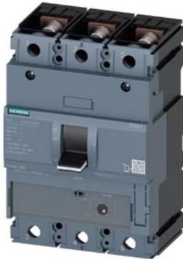
Interruttore automatico 3VA1 IEC Frame 250 Classe del potere di interruzione H Icu=70kA @ 415V a 3 poli, protezione avviatore TM120M, AM, In=160A senza protezione da sovraccarico protezione da cortocircuito li=7 ... 16 x In attacco piatto a vite
