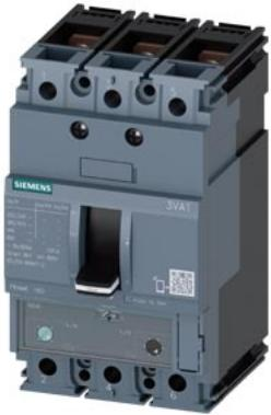
Interruttore automatico 3VA1 IEC Frame 160 Classe del potere di interruzione S Icu=36kA @ 415V a 3 poli, protezione impianto TM240, ATAM, In=16 A protezione da sovraccarico Ir=11 A ... 16 A protezione da cortocircuito li=10 ... 20 x In attacco piatto a vite
