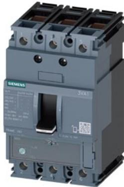
Interruttore automatico 3VA1 IEC Frame 160 Classe del potere di interruzione N Icu=25kA @ 415V a 3 poli, protezione impianto TM220, ATFM, In=16 A protezione da sovraccarico Ir=11 A ... 16 A protezione da cortocircuito Ii=20 x In connessione a morsetto
